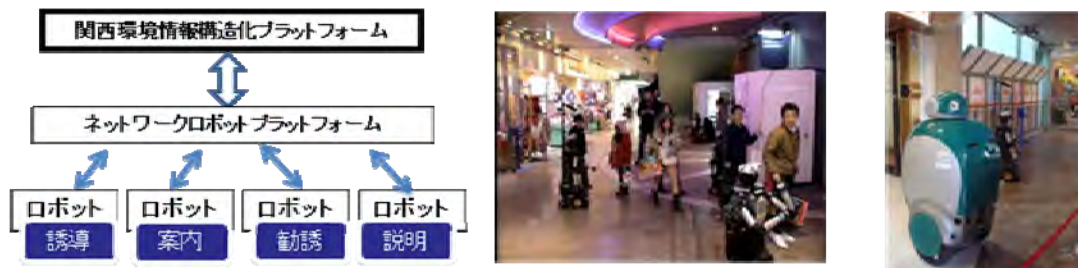
(a) ネットワークロボットとの連携 (b) ロボット4台が別々の客に対応 (c) DustBotが荷物運搬 図7 ネットワークロボットプラットフォームとの連携実験(ユニバーサルシティウォーク大阪)
