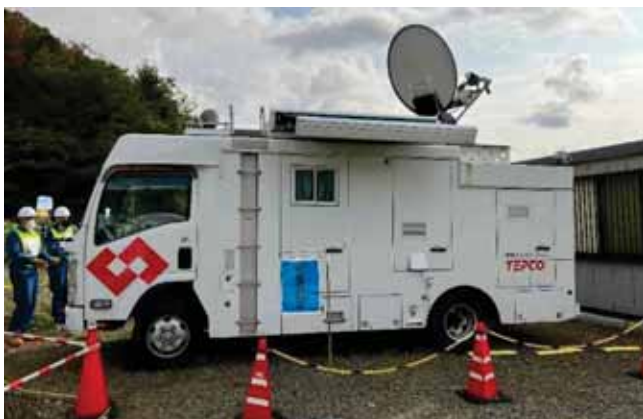
原子力事業所災害対策支援拠点運営訓練(衛星通信車)
