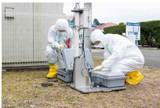
可搬型モニタリングポストの設置
