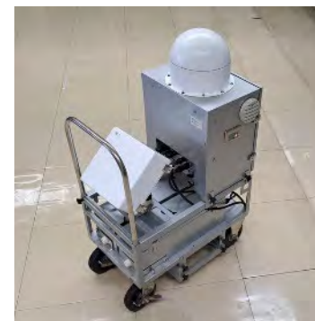
可搬型モニタリングポスト 【18台】
