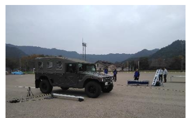
(写真14) ゲート型モニタを使った 車両検査
