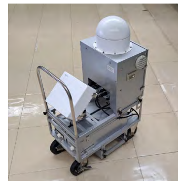
可搬型モニタリングポスト 【18台】
