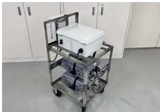
可搬型モニタリングポスト 【4台】
