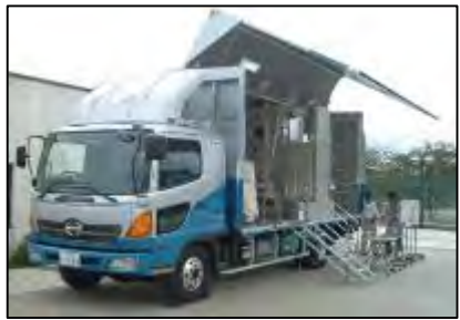
移動式体表面測定車(2台)
