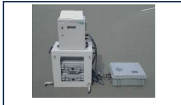
可搬型モニタリングポスト【10台】 (衛星回線等による通信機能付き)
