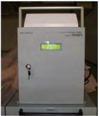
可搬型モニタリングポスト【12台】
