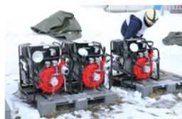
可搬型ポンプ
