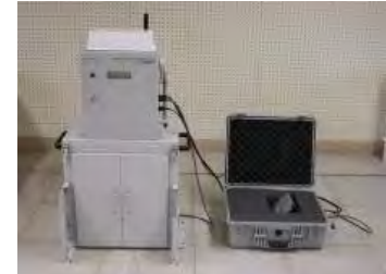
可搬型モニタリングポスト【1台】
