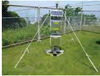
可搬型代替モニタ【5台】、可搬型モニタ【4台】 (無線による通信機能付)
