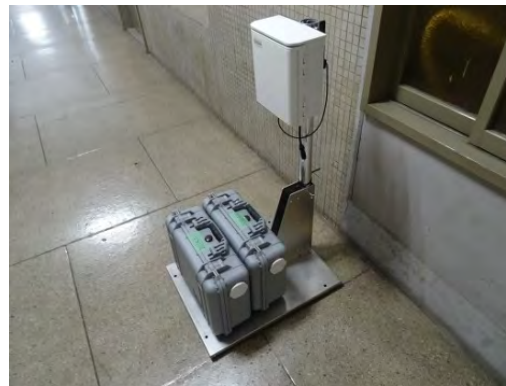
可搬型モニタリングポスト 【12台】
