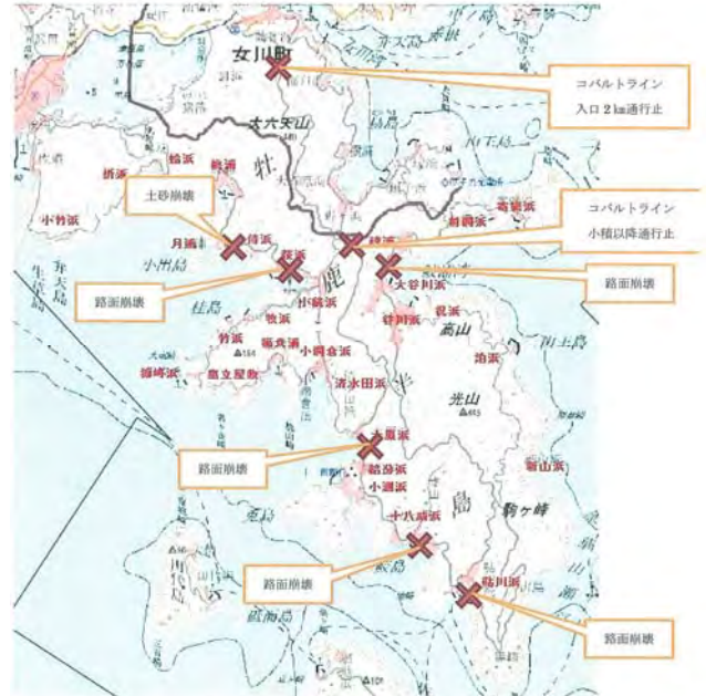
東日本大震災における半島部の道路被災状況 （石巻市提供資料）
