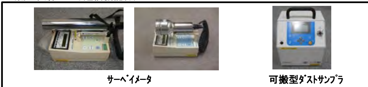
車両に搭載する可搬型放射線計測装置の例
