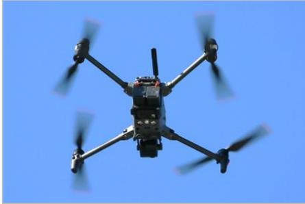
測定機器を搭載したドローン
