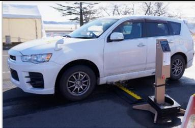
ゲート型モニタによる汚染検査
