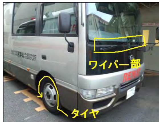
車両の外側で放射性物質が付着している可能性が高いワイパー部、タイヤを中心に検査・除染する
