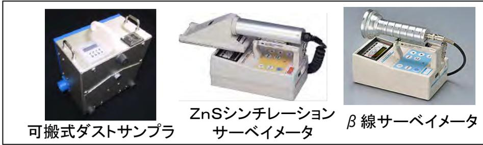
主な可搬型放射線計測装置の例
