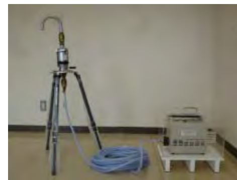
資機材例 【10台】 (可搬型ダストヨウ素サンプラー) 105
