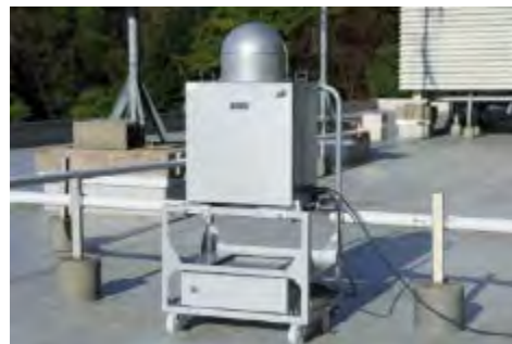
可搬型モニタリングポスト 【22台】
