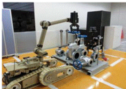
バルブの開閉操作
