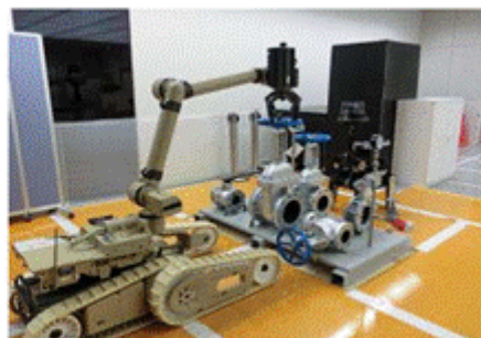
バルブの開閉操作
