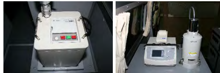
資機材例 (可搬型ダストヨウ素サンプラー)
