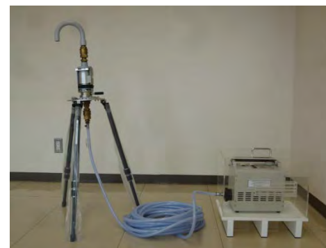
資機材例 (可搬型ダストヨウ素サンプラー)
