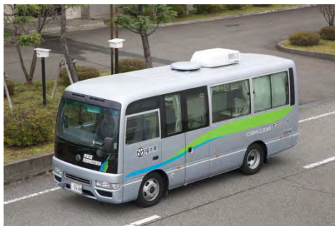
ガンマ線核種分析ラボ車 (高機能モニタリングカー)
