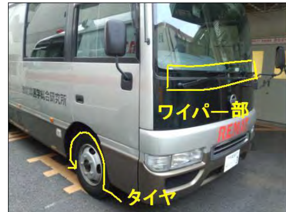
車両の外側で放射性物質が付着している可能性が高いワイパー部、タイヤを中心に検査・除染する
