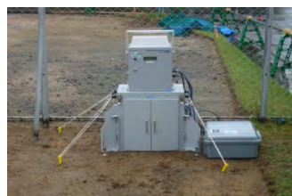
可搬型モニタリングポスト【5台】 (衛星電話等による通信機能付)
