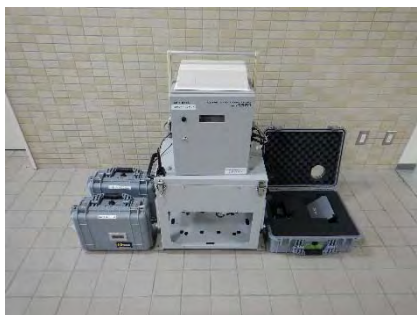
可搬型モニタリングポスト【14台】 (蓄電池装備、携帯・衛星電話通信機能付)
