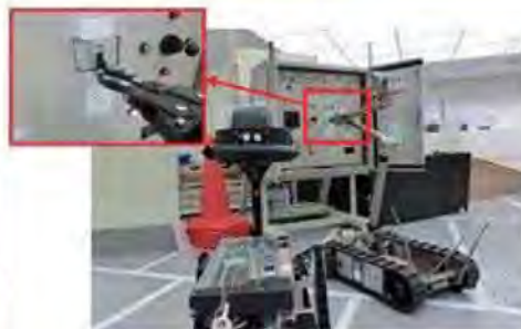
制御盤を開放しスイッチ操作
