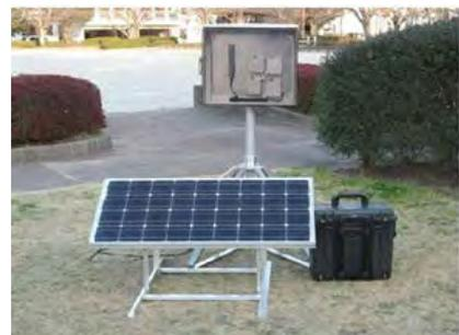
GPS追従型線量率測定装置【30台】
