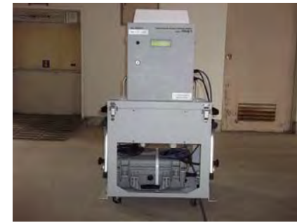
可搬型モニタリングポスト【14台】 (蓄電池装備, 携帯電話通信機能付)
