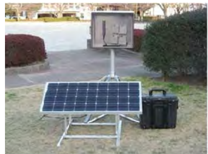
GPS追従型線量率測定装置【30台】
