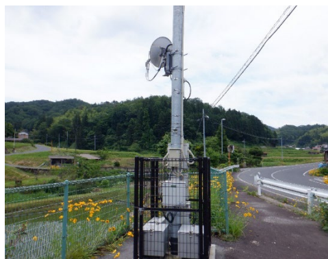
電子線量計 【125局】 (バッテリー付)
