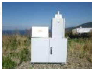
可搬式モニタリングポスト【9台】 (衛星系回線による通信機能付)
