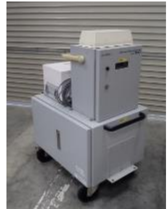
可搬型モニタリングポスト【11台】 (バッテリー付)
