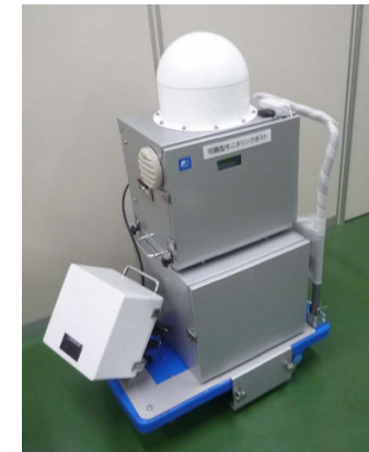
可搬型モニタリングポスト【3台】 (バッテリー付)
