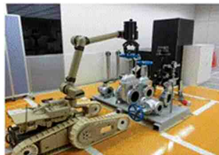
バルブの開閉操作
