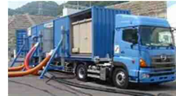
移動式代替熱交換設備
