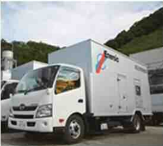
高圧発電機車
