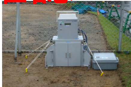
可搬型モニタリングポスト (衛星電話等による通信機能付)
