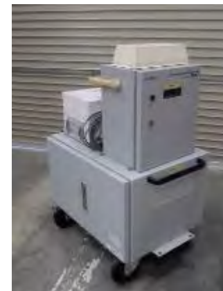
可搬型モニタリングポスト 【11台】 (バッテリー付)
