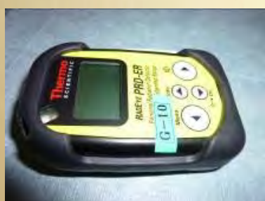
Thermo製 広帯域NaI(Tl)シンチレーションサーベイメータ RadEye PRD-ER
