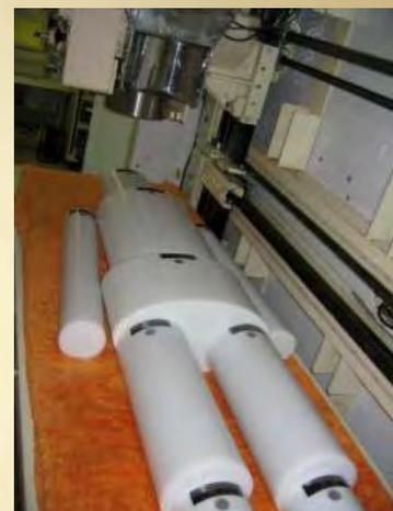
国家基準で検定された既知放射能を含むBOMABファントムを標準線源として校正する
