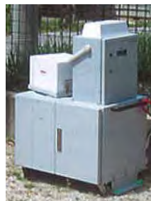
可搬型モニタリングポスト (常設、蓄電池装備)
