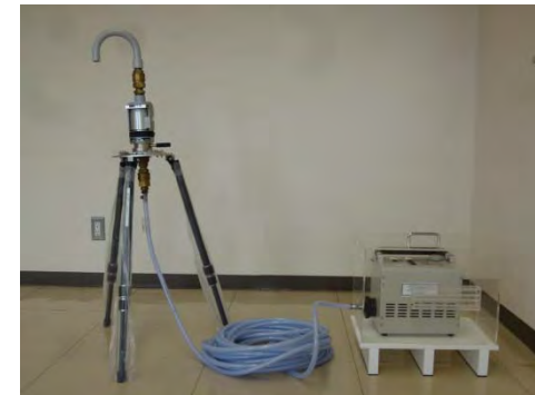
資機材例【18台】 (可搬型ダストヨウ素サンプラー)
