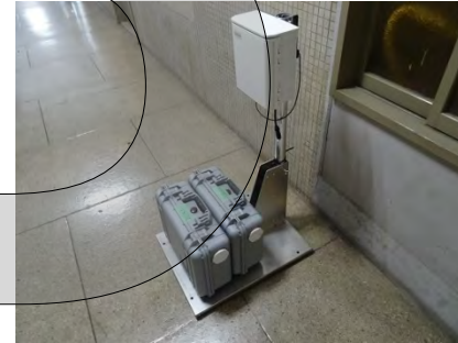
可搬型モニタリングポスト【12台】
