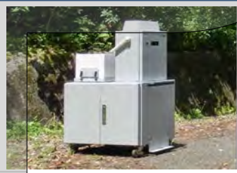
可搬型モニタリングポスト 【8台】 (衛星系回線による通信機能付)
