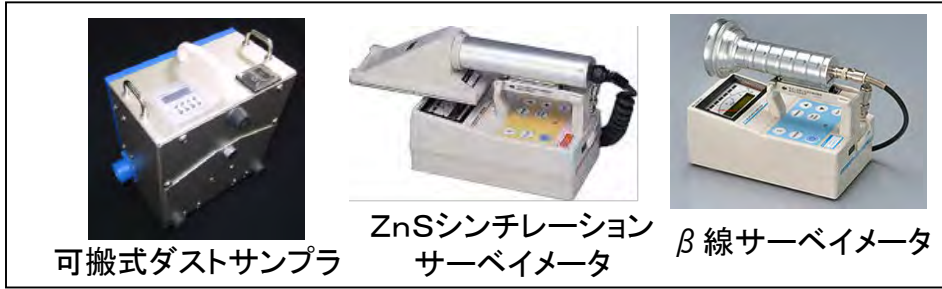
主な可搬型放射線計測装置の例
