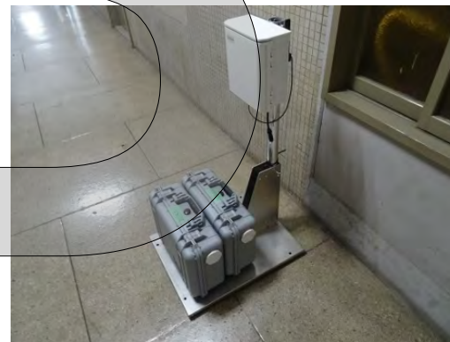
可搬型モニタリングポスト【12台】
