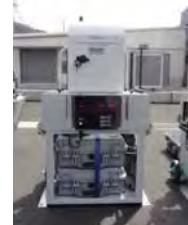
可搬型モニタリング ポスト【7台】 (バッテリー付)
