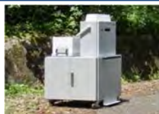
可搬型モニタリングポスト【8台】 (衛星系回線による通信機能付)
