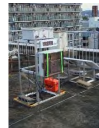
可搬型モニタリングポスト 【5台】 (太陽光パネル+バッテリー付)
