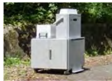
可搬型モニタリングポスト【10台】 (衛星系回線による通信機能付)
