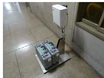
可搬型モニタリングポスト【12台】
