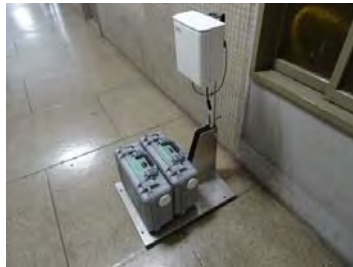
可搬型モニタリングポスト【12台】
