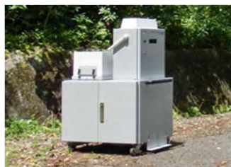
可搬型モニタリングポスト【10台】 (衛星系回線による通信機能付)
