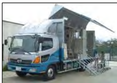
移動式体表面測定車(2台)
