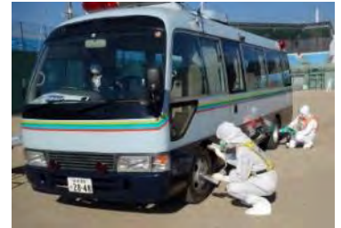
(写真 6-2) 放射線測定器による検査 (車両)
