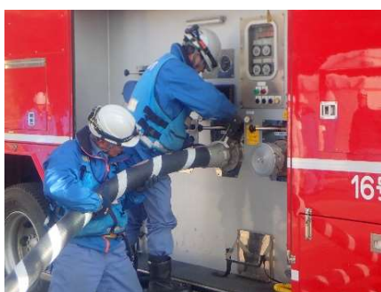
＜可搬型大型送水ポンプ車による使用燃料ピット(SFP)スプレィ＞
